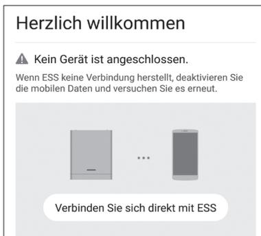
Wird die Verbindung zum System erstmals hergestellt, wird der Bildschirm zur Auswahl der Verbindungsmethode angezeigt.
