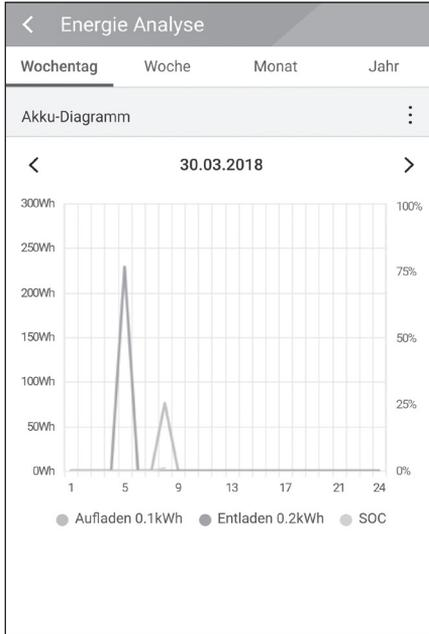
Unter [Energieanalyse] die Option [Batt Graph] auswählen.
