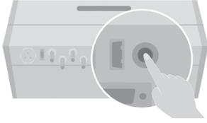
Drücken Sie die WLAN-Taste an der Unterseite des ESS und gehen Sie zum Menü Einstellungen > WLAN und wählen Sie ESS, um eine Verbindung herzustellen. ESS Wi-Fi-Passwort ist Wi-Fi Key auf der rechten Seite des ESS-Geräts.
